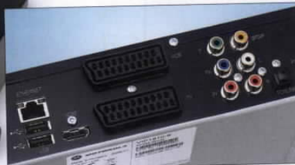
■ Spajanje na ADSL modem obavlja se standardnim mrežnim kablom, a na televizor putem SCART-a
